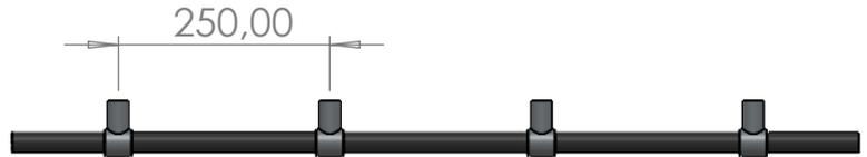
Sickenfüller für das HDD Innenblech aus EPDM
